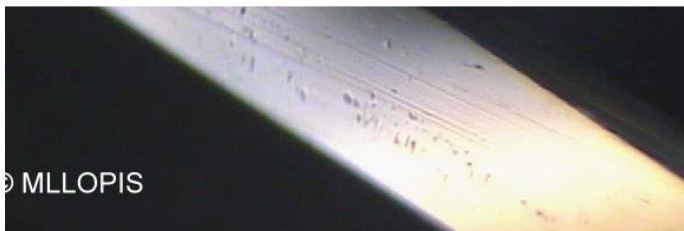
Estrias de crecimiento de la capa de diamante sintético CVD en el filetín.
