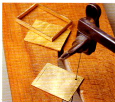
▲ 16. Obtenida la pieza, se prepara la estructura del broche con un hilo rectangular y un marco interior calado.
