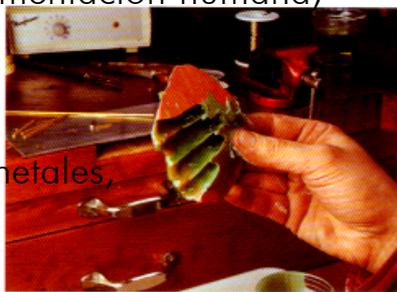
▲ 9. Cuando la cera caliente entra en contacto con la superficie fría del molde se solidifica al instante; para lograr una superficie uniforme e igualada, se debe verter la cera y, a continuación, mover el molde para que ésta fluya por toda la superficie.
