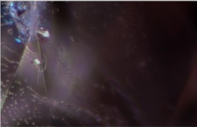
*FRACTURA INTERNA Y BIFÁSICAS. LUZ DE CAMPO OSCURO, 30X.*
