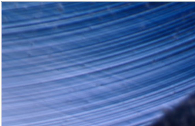
BANDAS CURVAS DE COLOR EN UN ZAFIRO SINTETIZADO POR EL MÉTODO VERNEUIL
